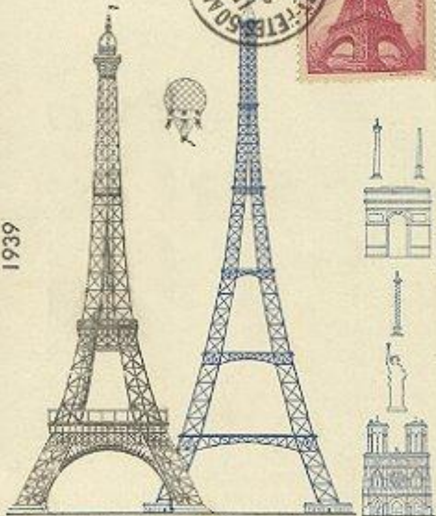
La Tour Eiffel en 1939 et le premier projet imaginé en 1884, par M. Maurice Koechlin
